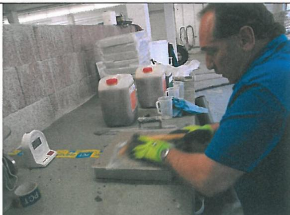
Bild 5: Glätten des Prüfkörpers
